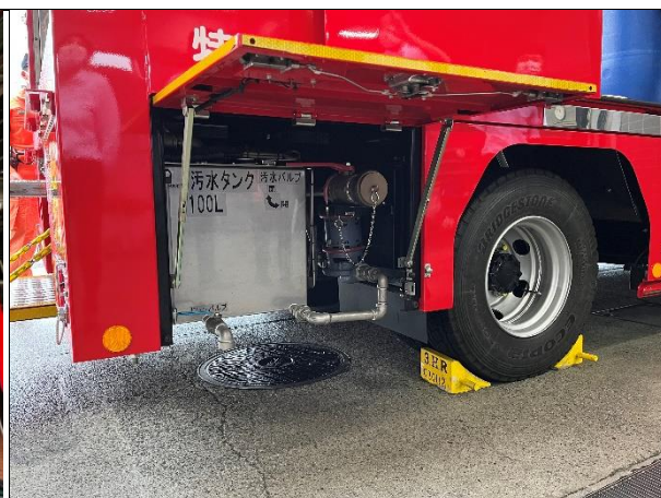
圖 5-10 除污車另設 100L 水槽
