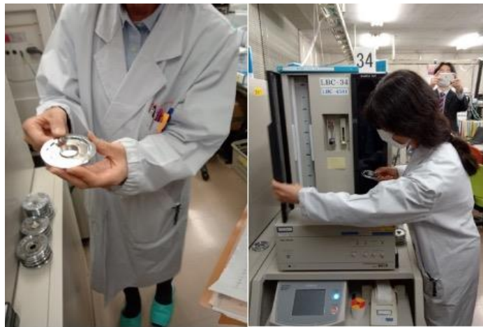
圖 34、JCAC 人員示範將處理後的樣品滴至樣品盤內
