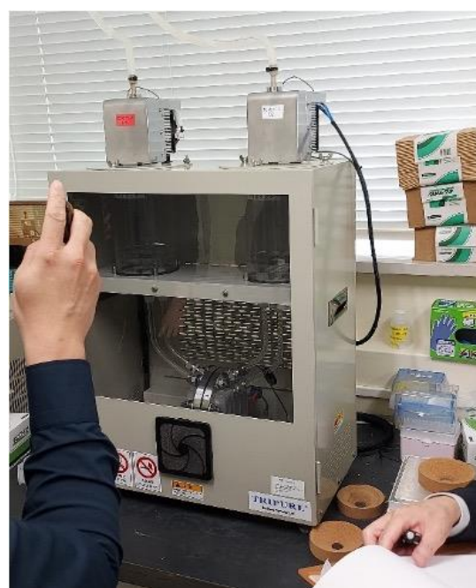
圖 47、MERI 的固體聚合物電解質式氬濃縮裝置
