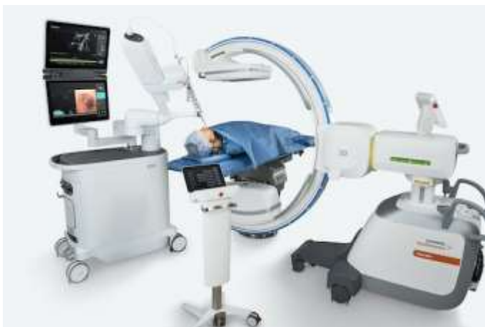
圖 5 機器人輔助支氣管鏡平台(Ion 系統)
