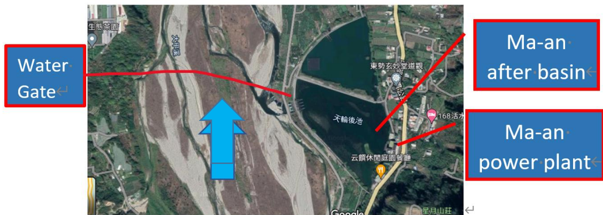
圖 103 發電廠尾水出口建置後池圖
