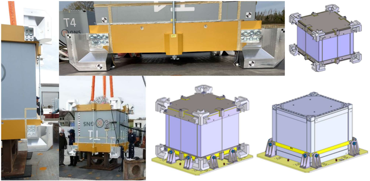
圖 4 T1-Box 運輸包件吸震器結構強化示意圖
