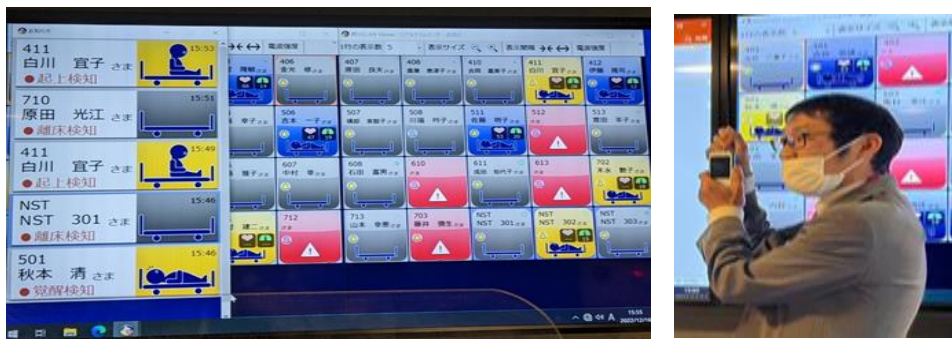
長輩離床警示系統(圖左)，員工展示每位長輩配有緊急呼叫拉式手機(圖右)
