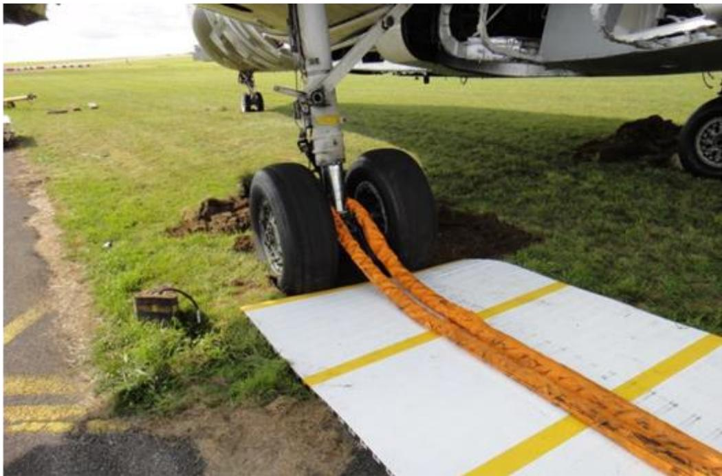
圖 11：航空器搶救耐力複合板鋪設及航空器救援拖索組拖曳移離組合示意圖
