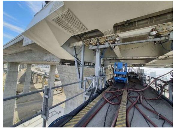
圖 56 橋梁檢測維修車配備剪刀式高空作業車，據工程師表示不實用。維修車上管線雜亂，有改善空間。
