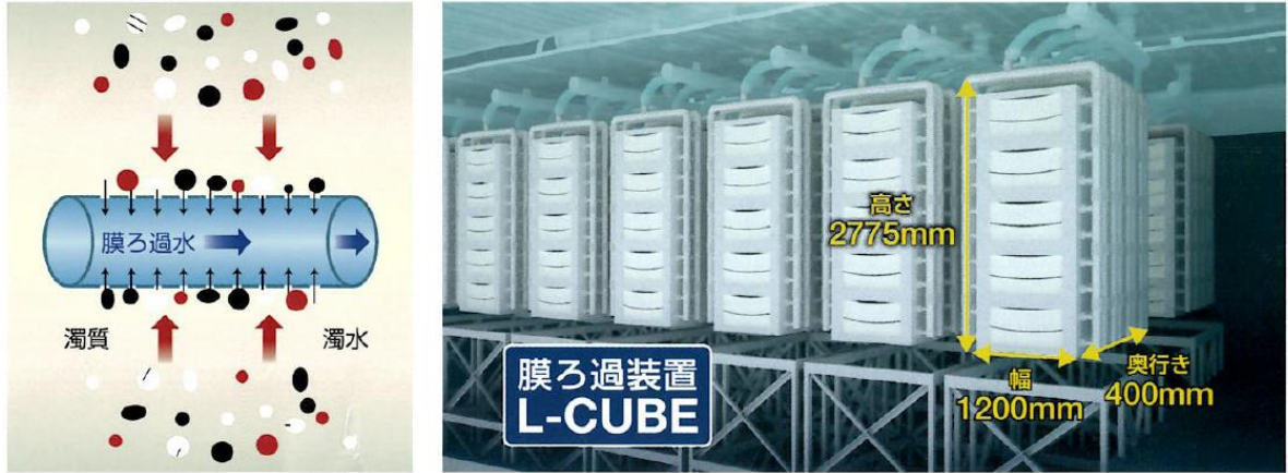
圖 2-18 佐野淨水場採用之薄膜膜組示意圖
