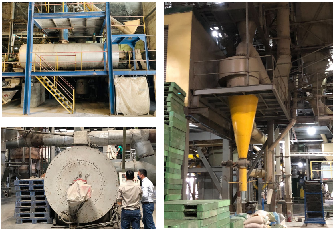
圖 4-5 肉骨粉機 (左上)、發酵豆粉熱風乾燥機 (左下) 與不對稱飼料暫存桶 (右)
