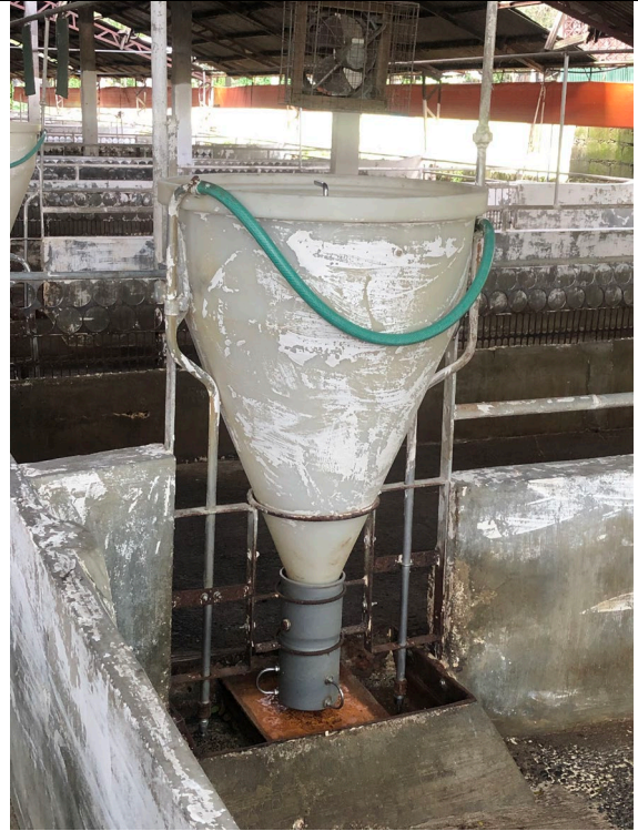
當豬用鼻子頂飼料桶下方的鐵環時，塑膠水管會轉動，飼料就可以掉落至飼料槽，兩旁也有飲水器
