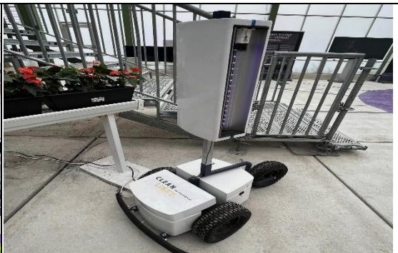
圖 66.溫室自走式紫外燈殺菌機器
