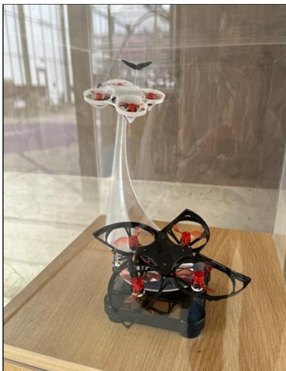
圖 63.無人機搭載鏡頭，並且以螺旋槳除滅蛾類，運用在溫室害蟲監測與防治
