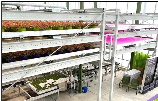
圖 65.層架栽培花卉盆栽搭配 LED 電照
