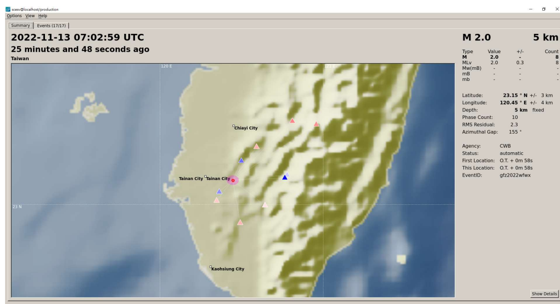
圖 15、scesv 功能為呈現最新一筆自動定位的地震事件，並可從中得知地震規模、發震時間與地震位置等相關資訊。
