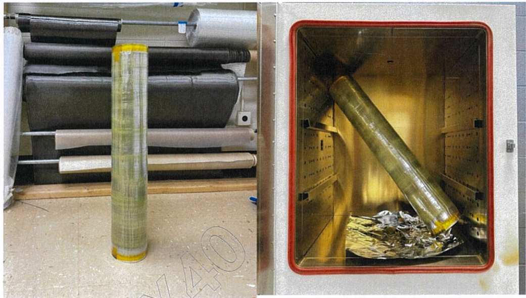
圖 12. 管材完成收縮膠帶包裹(左)及約 30 英寸管材放入烤箱(右)
