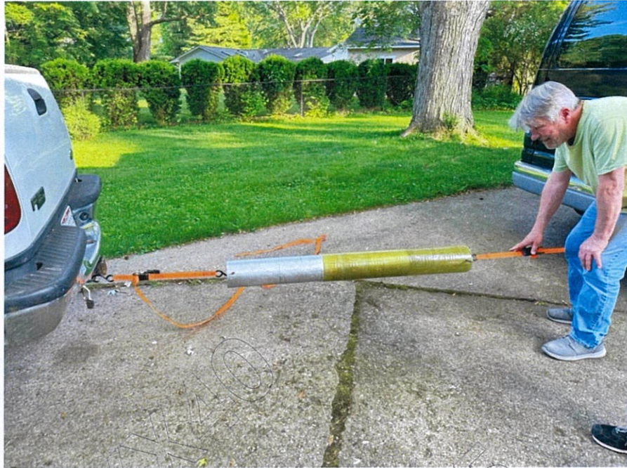
圖 14. 友人協助採車輛引拔方法將機身管材取出
