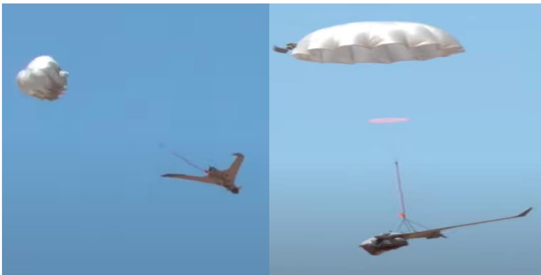
圖 86、Orbiter 4 開啟降落傘(1)開啟緩衝墊(2)示意圖
