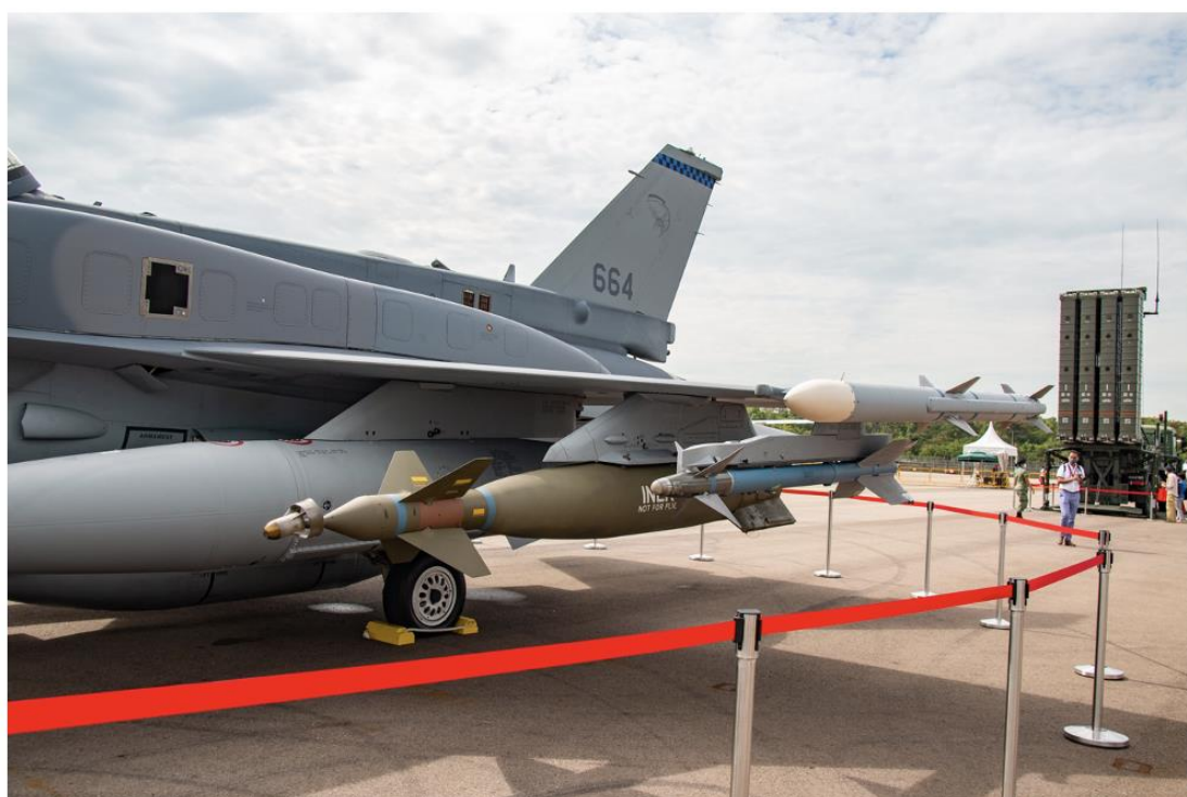
圖 153、F-16D 戰機機翼武器掛載及機背適型油箱
