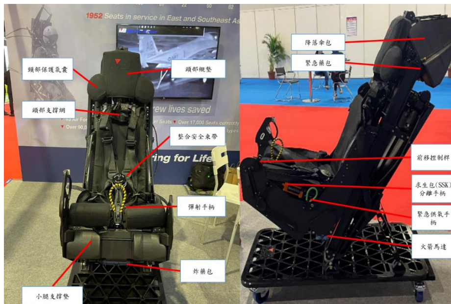
圖 97、MK-18 彈射座椅組成說明
