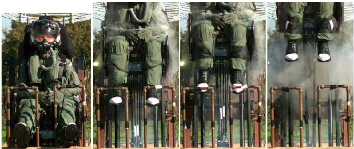
圖 100、MK-18 型座椅腳部防護束帶
