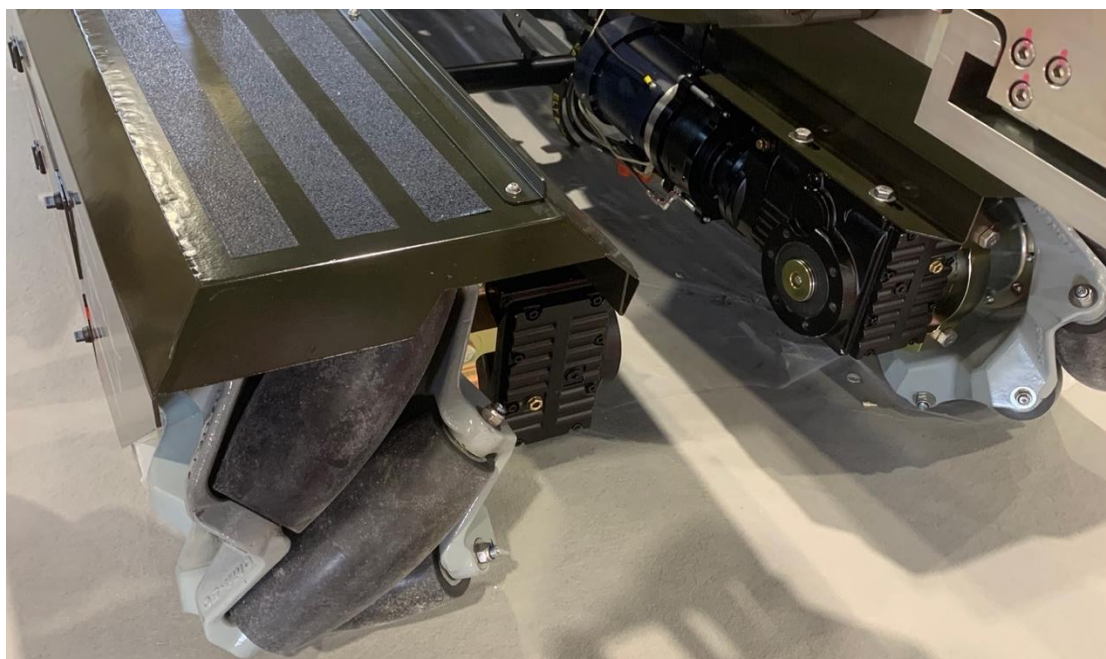
圖 95、彈藥裝載車斜向車輪設計
