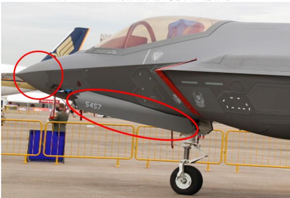
圖 15、F-35A 起落架艙門及雷達罩與機身鋸齒接合處
