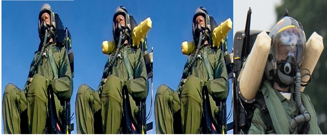
圖 99、MK-18 型座椅頭部防護氣囊
