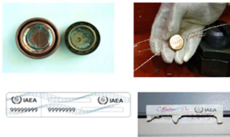
圖7：金屬封緘（資料來源：IAEA 網站）
