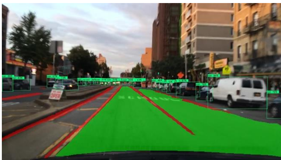
圖 9：模型檢測結果，方框代表檢測物體，紅線代表車道線偵測，綠色代表可行駛道路
