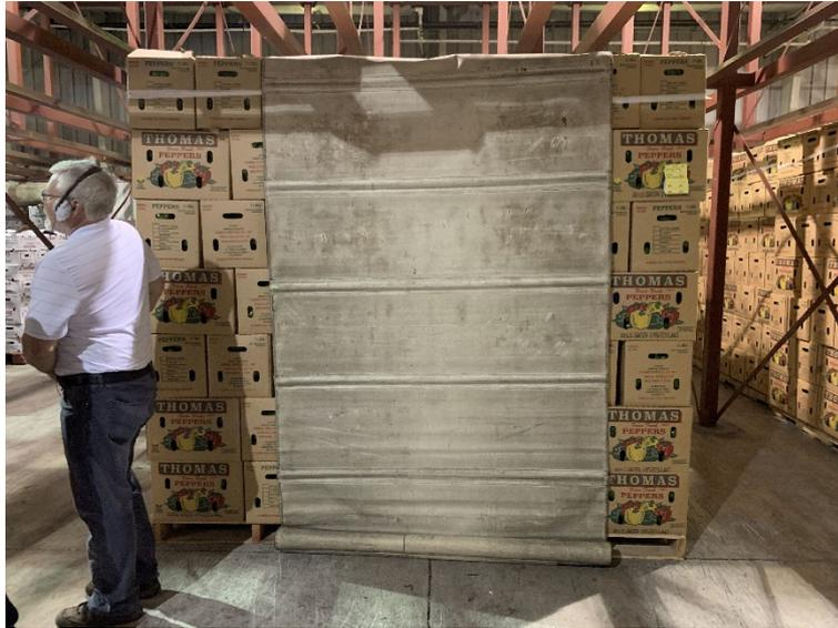
圖十六、隧道式壓差愈冷
