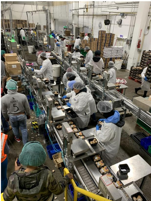
圖二十、蘑菇採收後進行裝盒→秤重→包膜→品質檢查→裝箱作
