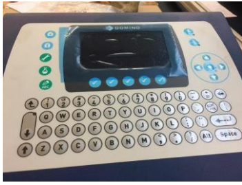
圖 61 噴印機控制器
