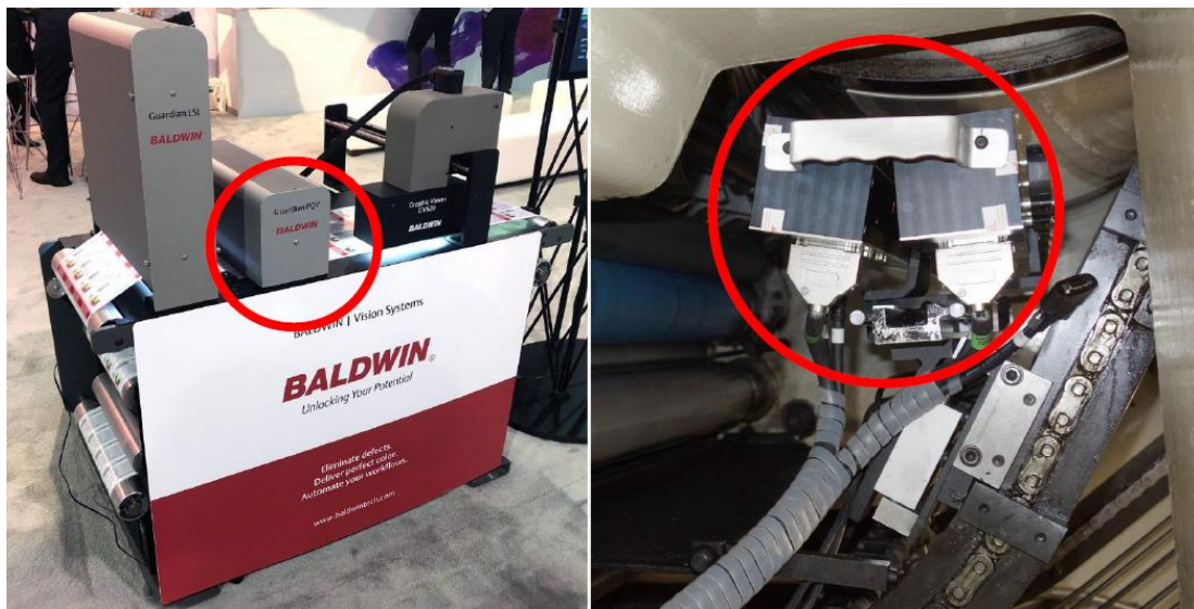
圖26可安裝於小型檢測機與印刷機上的CIS影像擷取與照明系統
