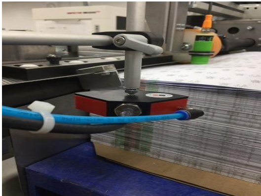
圖 68 三角扇形電離器
