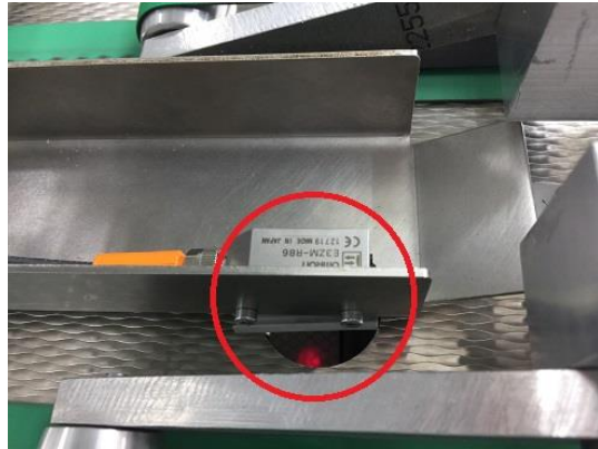
圖 79 紙堆循環觸發感測器
