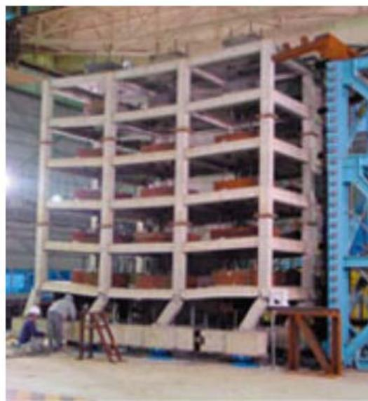
鉄筋コンクリート建物の振動破壊実験(1/3スケール)
