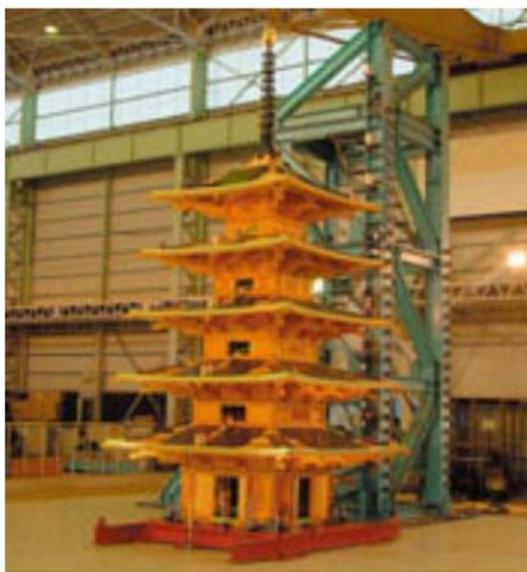
五重塔の振動実験(1/5スケール)
