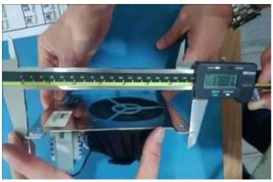
圖 88 車廂喇叭尺寸量測
