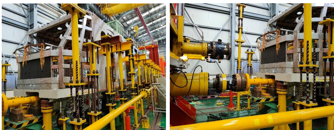
圖 94 車身負荷測試設備
