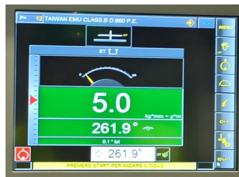
圖 69 動平衡測試結果
