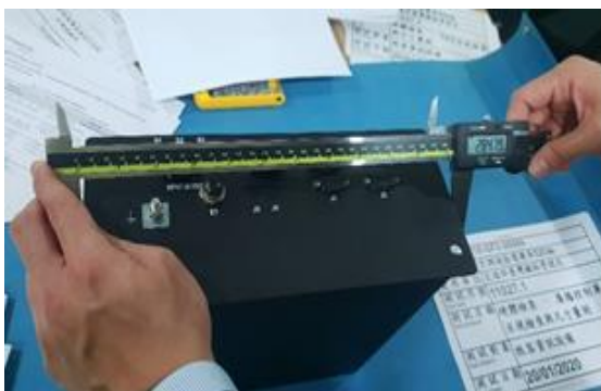
圖 87 廣播控制單元尺寸量測
