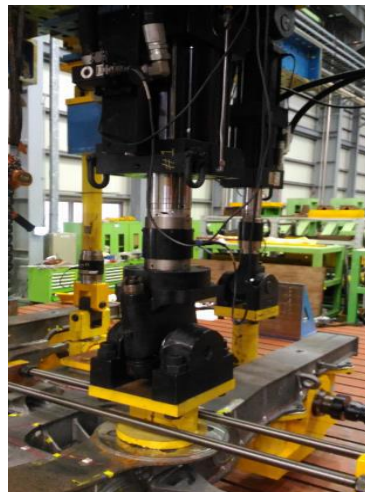
圖 12 垂向荷載傳感器(校驗)確認
