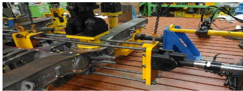
圖 11 橫向荷載傳感器(校驗)確認
