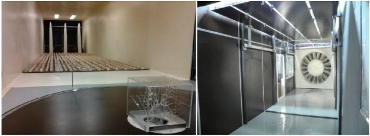
圖 2 捷克 ITAM 風洞內部地況及風扇
