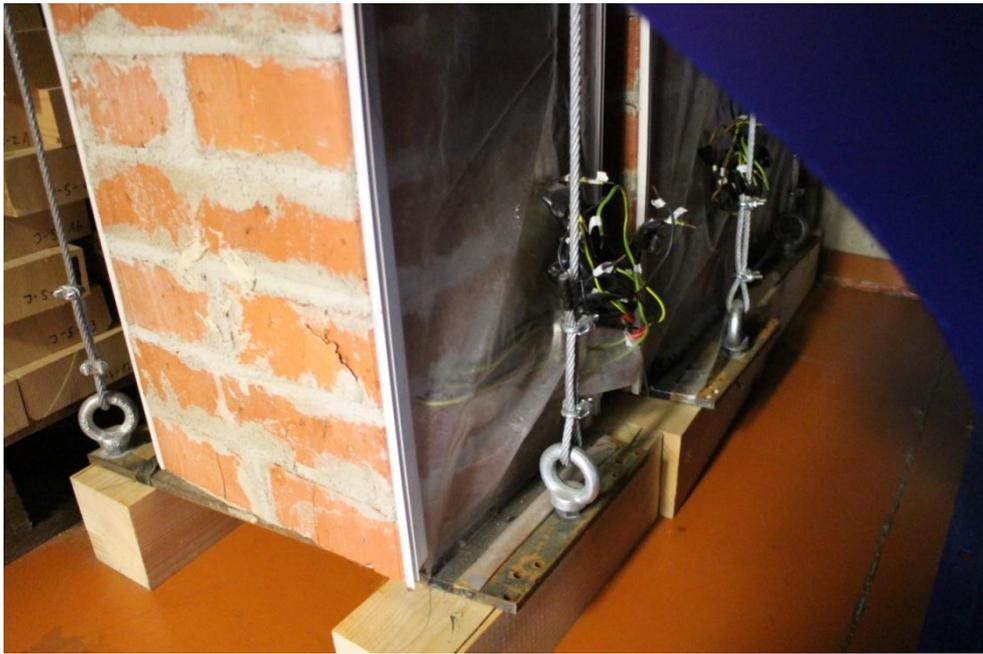
圖 17 磚牆試體內埋設溫濕度量測計
