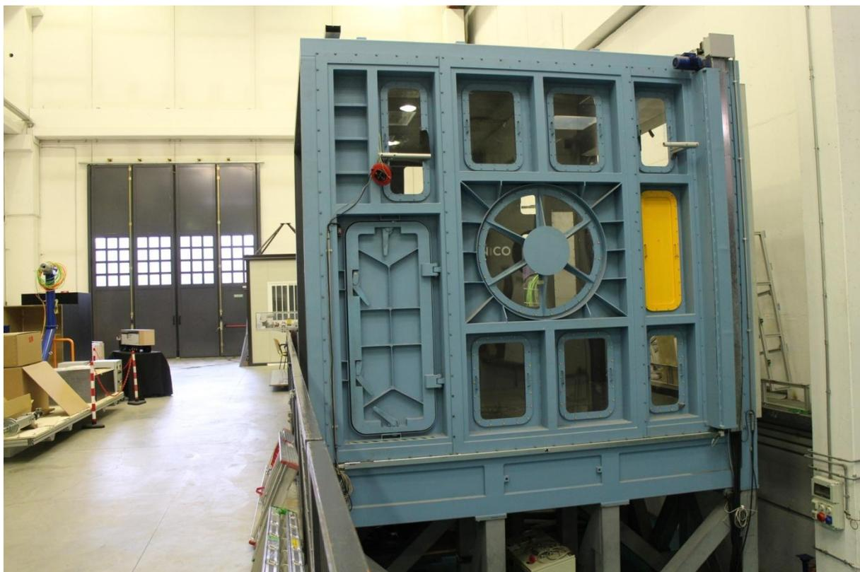
圖 43 可移動式低紊流測試艙
