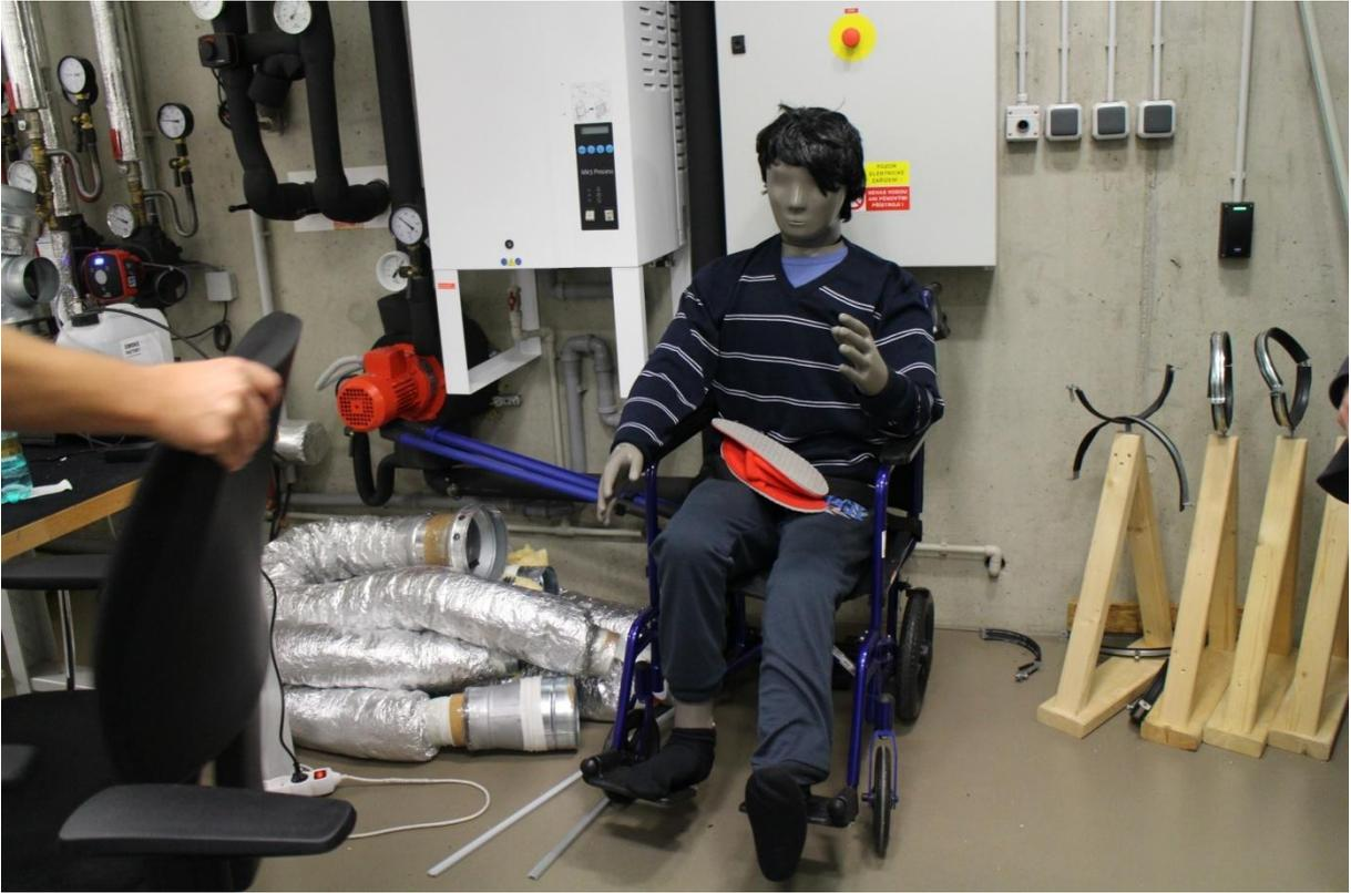
圖 27 人體模型熱感試驗
