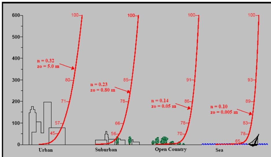
圖 52 不同地況下平均風速隨高度之變化示意圖
