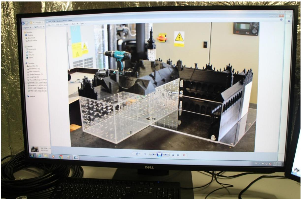
圖 15 風洞實驗室建置古蹟模型量測牆體表面風壓
