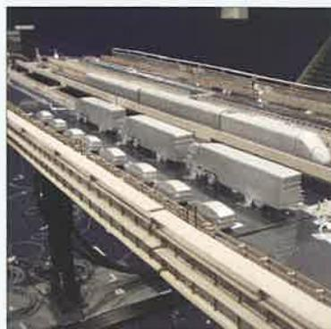
Grazie alle grandi dimensioni della camera di prova a strato limite è possibile condurre una vasta varietà di studi: l'effetto del vento su edifici, ponti, veicoli, imbarcazioni a vela e cavi tesi.
