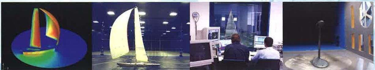
La dinamica del flusso attorno al veicolo è studiata sia con tecniche di visualizzazione di flusso (vedi figura centrale) sia mediante misure di pressione sulla superficie esterna del modello. A queste indagini sperimentali, sono affiancati studi numerici con codici di calcolo fluidodinamici (CFD) che permettono di interpretare fisicamente i risultati sperimentali ottenuti e di realizzare analisi di sensibilità al variare di parametri aerodinamici ritenuti significativi (vedi figura in basso).
