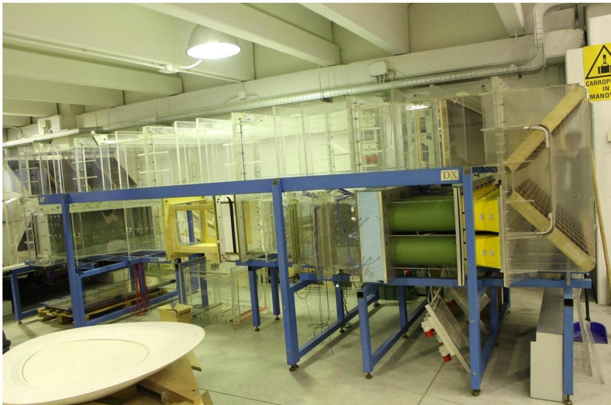
圖 41 GVPM 風洞縮小模型
