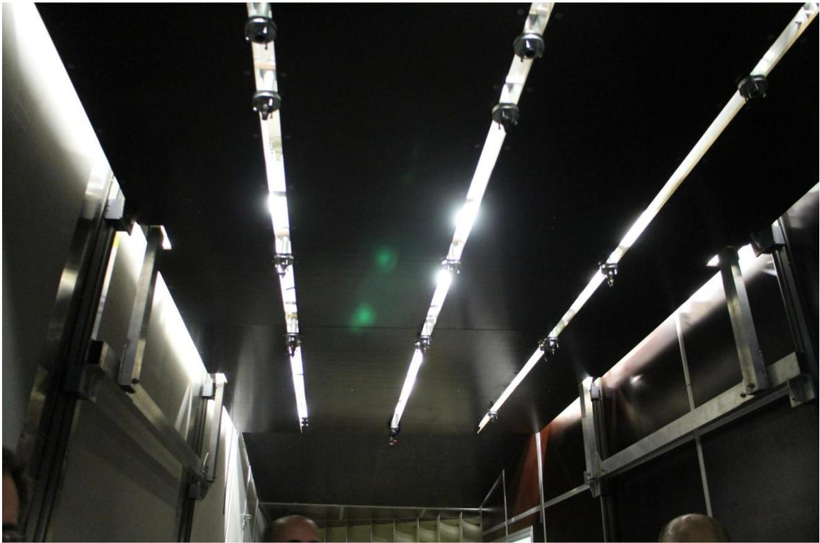
圖 10 捷克 ITAM 風洞實驗室環境測試段內噴水系統
