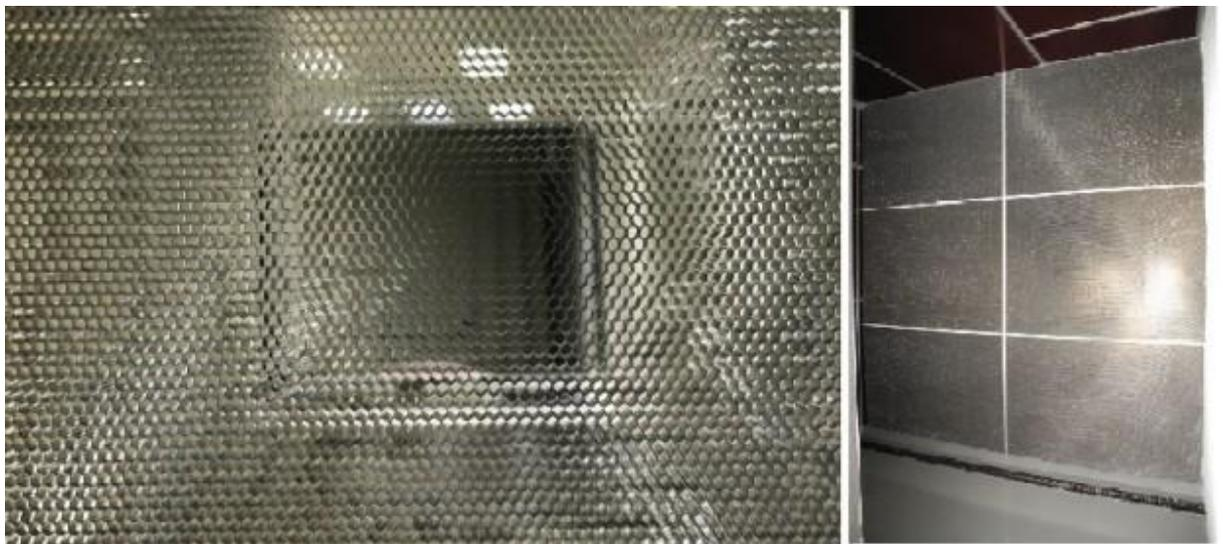
圖 3 捷克 ITAM 風洞蜂巢網
