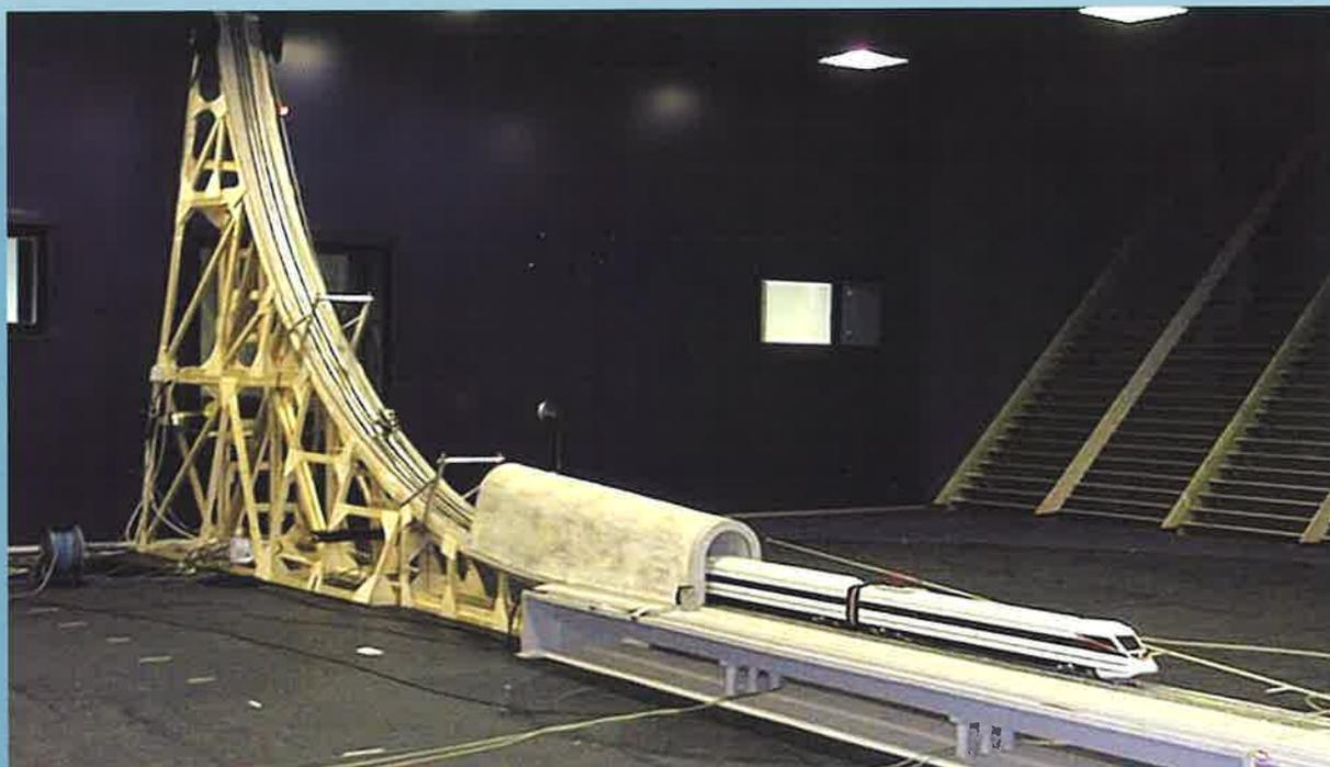
Le prove in Galleria del Vento su veicoli hanno l'obiettivo di studiare il rischio di ribaltamento associato al vento trasversale. Le forze aerodinamiche agenti sui modelli di veicoli in scala sono misurate mediante una bilancia dinamometrica a sei componenti al variare dell'angolo di incidenza (angolo tra la direzione del veicolo e della velocità del vento).
