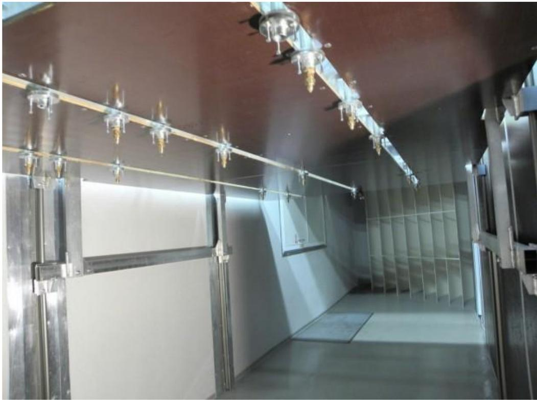
圖 5 捷克 ITAM 風洞內噴水系統
