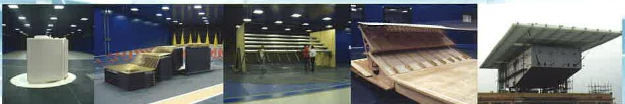
La Galleria è dotata di un sistema di misura di pressione multicanale, per il rilievo della distribuzione di pressione sulla superficie del modello, e di numerosi sensori miniaturizzati per il rilievo dinamico di pressioni con elevatissima frequenza di campionamento.
