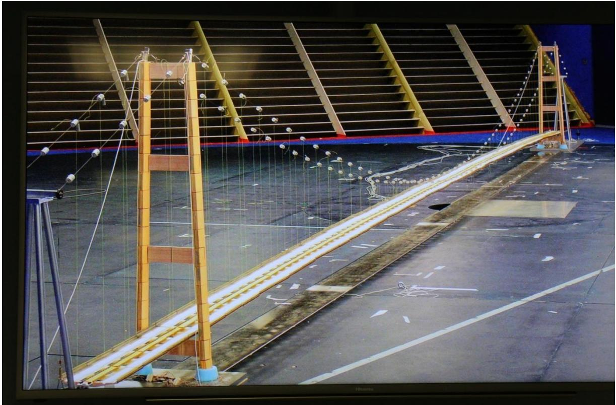
圖 39 懸索吊橋風洞試驗
