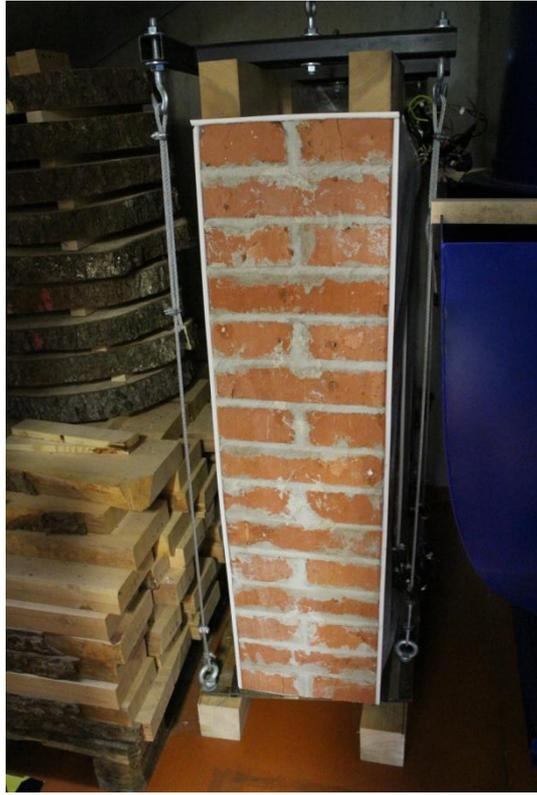
圖 16 風洞實驗室磚牆試體
