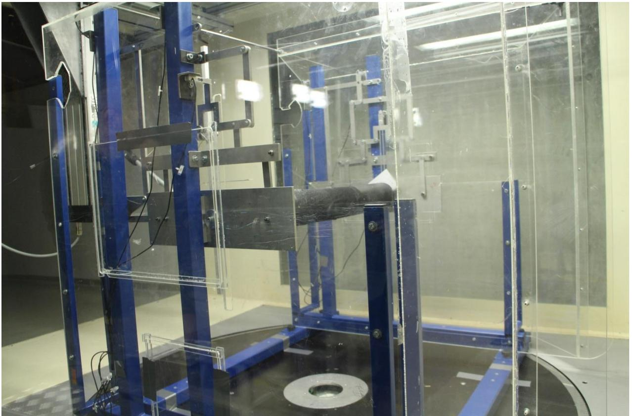
圖 11 捷克 ITAM 風洞實驗室內橋樑斷面測試
