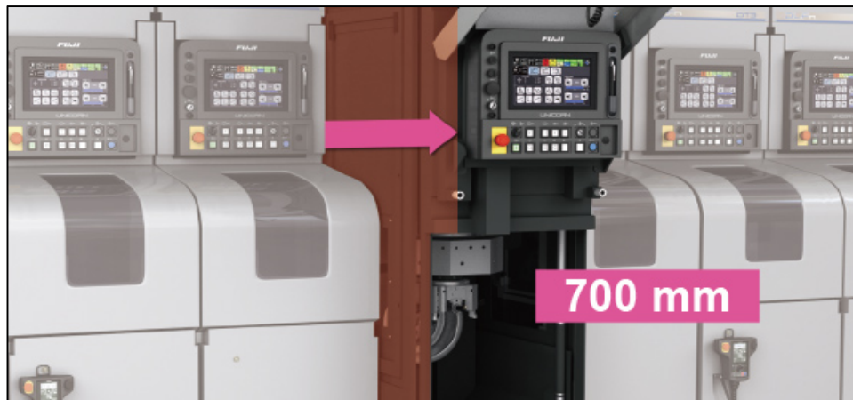
圖 6 機械模組可以從前方抽出 700mm，可以容易地進行換線生產
