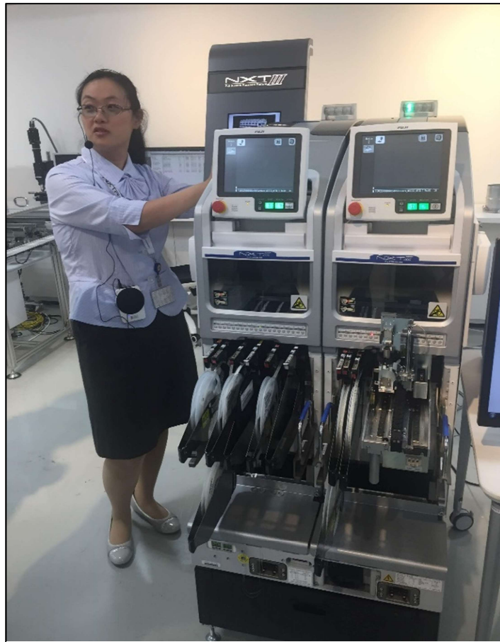
圖 2 NXT III 模組型高速多功能黏著機功能講解
