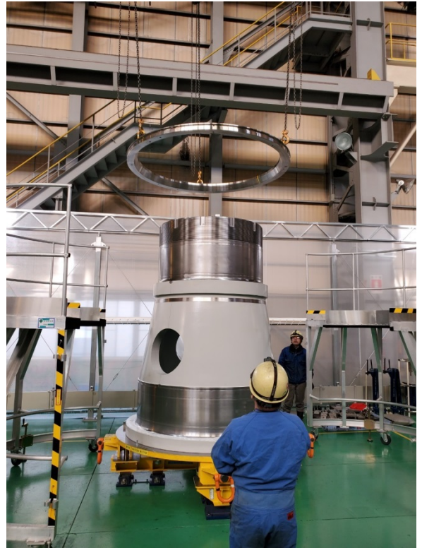
固定主軸與軸承之熱收縮配合
