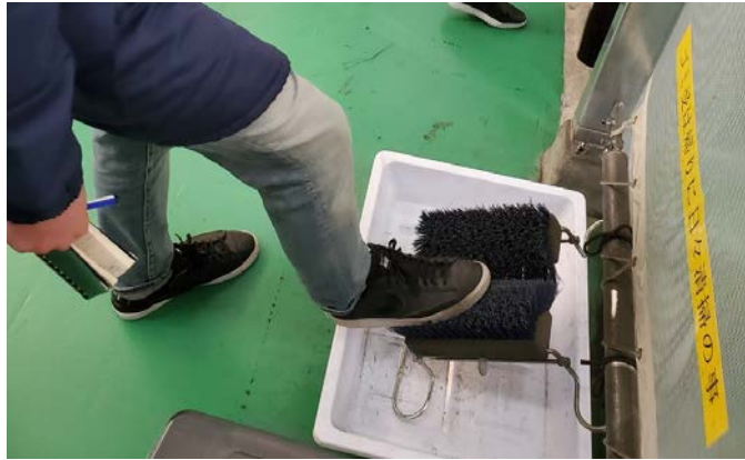
圖 18_進入加熱區前作鞋部落塵處理
