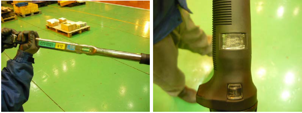
圖 35_現場確認扭力扳手有儀器校正(左圖) 圖 36_現場確認扭力扳手鎖緊轉矩值(右圖)
