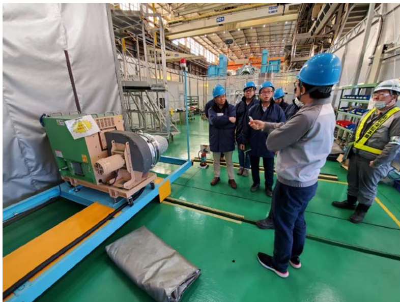
圖 24_輪轂加熱所採用之加熱器(加熱時有警示燈閃爍)
