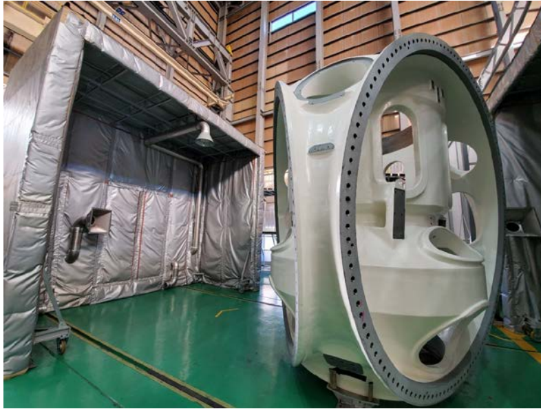
圖 23_輪轂罩加熱所採用之隔熱帳
