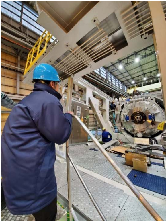
圖 14_組裝人員使用螺栓張力器進行組裝齒輪箱固定架
