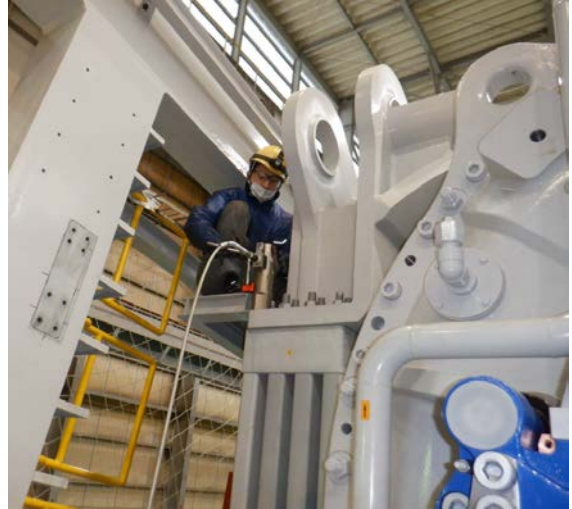
圖 14_組裝人員使用螺栓張力器進行組裝齒輪箱固定架
