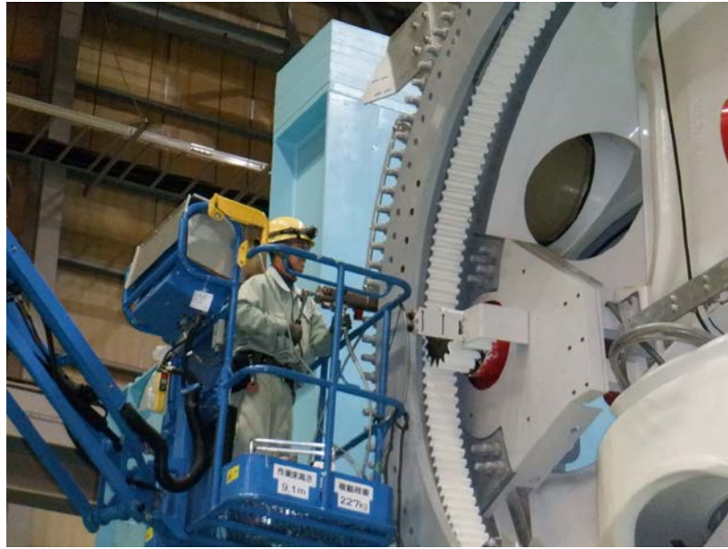
圖 33_旋翼軸承安裝至輪轂本體
