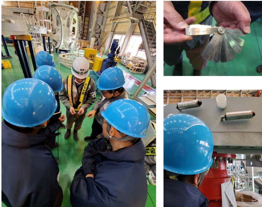
圖 30_工程人員說明測量尺輪間隙用間隙規(左圖)
