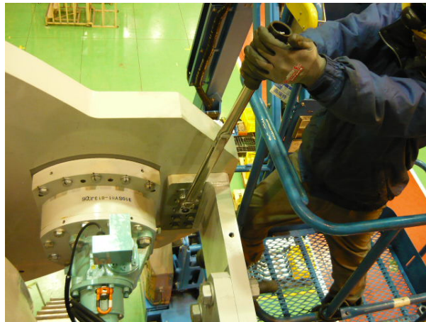
圖 37_工程人員以扭力扳手鎖緊轉子鎖
