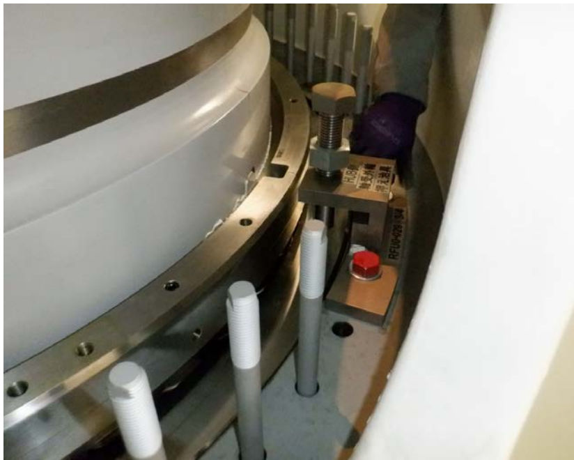
圖 26_測力器確認固定主軸與輪殼收縮配合後的加壓管理
