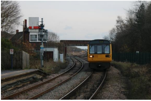
圖 29、希爾登(Shildon)車站的出發號誌機已改成電子機械方式運作，但外觀仍維持臂木式號誌機樣貌，圖中的列車為 Class 142 型柴油客車。
