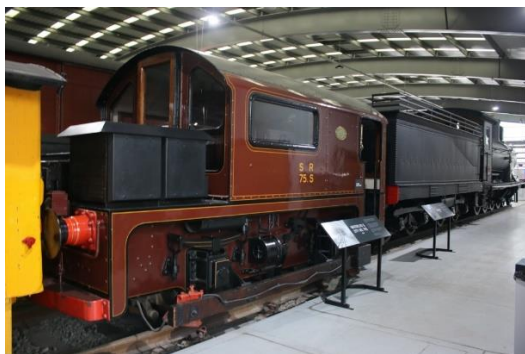
圖 27、倫敦地鐵 75S 電力機關車 該輛電力機關車造於1898年，原行駛於倫敦地鐵滑鐵盧線(Waterloo & City line)，可以看
