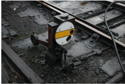
圖 73、泰斯利機車廠區內調車用號誌，由照片中可以看到該號誌機由號誌樓那一方利用鋼索去控制。
