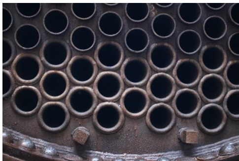
圖 71、修復中的蒸汽機車鍋爐的煙管，其收邊處以閩管方式處理，這項鍋爐煙管製作的傳統工藝，在國內已喪失技藝，近年來都使用焊
