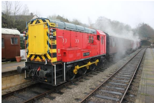
圖 54、Class08 型柴電調車機作為蒸汽列車的輔助機車，車廂冒出的蒸汽是由於車廂暖氣管老舊外洩所致，反倒成為一種特色。
