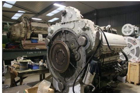
圖 51、Deltic 柴油機車特殊的 V 型汽缸引擎。
