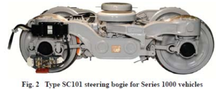
圖 32 可動式轉向架(steering bogie)之原理及應用
