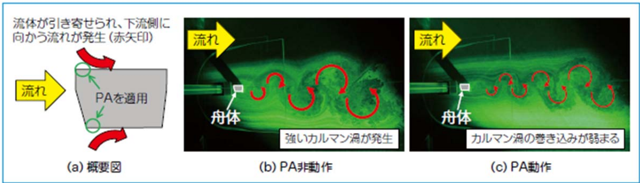
図6 現用舟体にPAを適用した場合の流れの可視化結果
