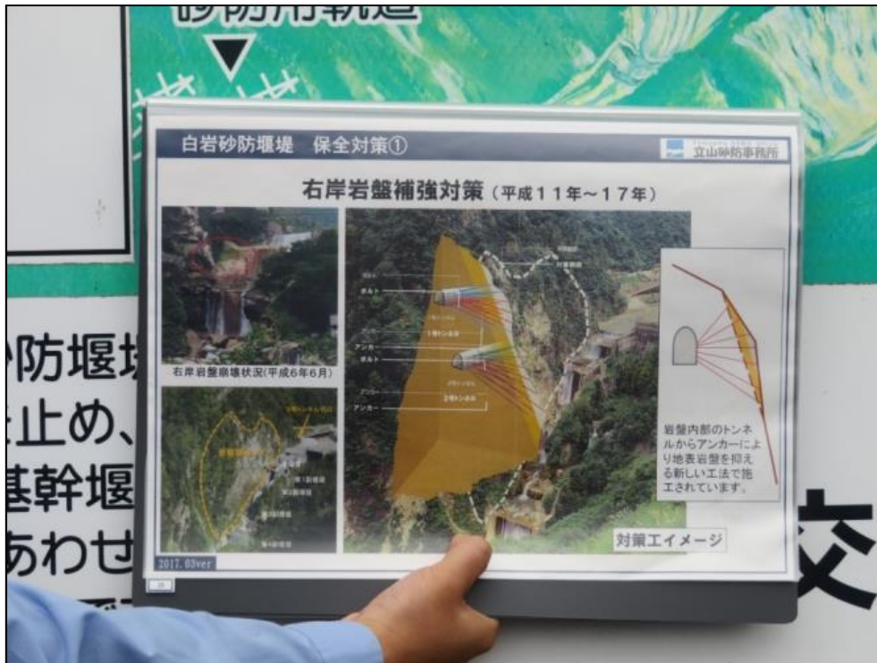
圖 37 白岩砂防堰堤右岸補強對策
