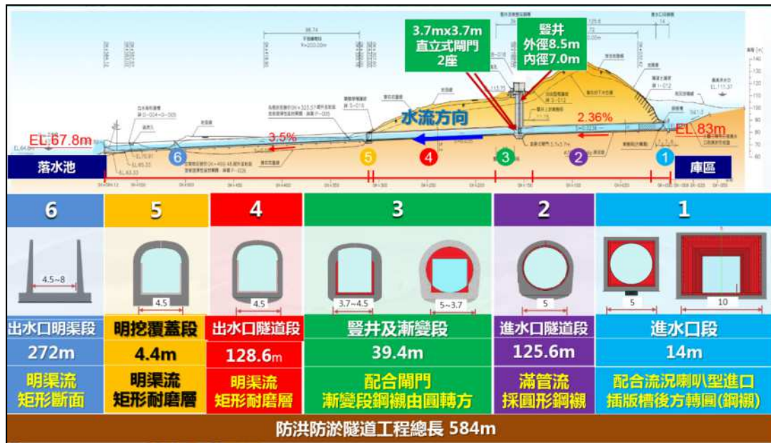
圖 26 白河防洪防淤隧道縱斷面圖
