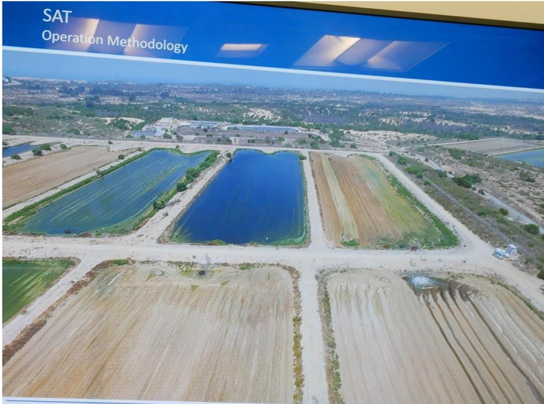
圖 4-17 廢污水處理後地下水補注池
