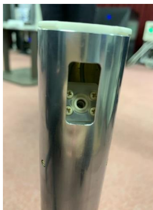
照片 3 (左)：探頭髮射及接收拉莫頻率訊號之通道
