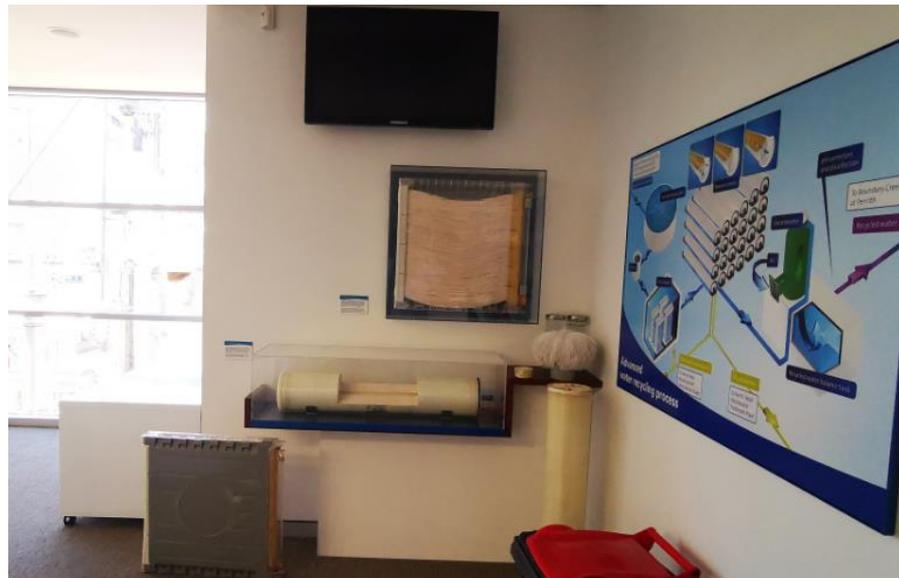
圖 3.8-9 環境教育中心擺設 UF 薄膜及 RO 逆滲透薄膜
