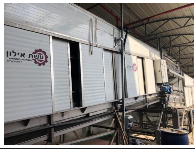
圖二十、柑桔採後之清潔與風乾設備。
