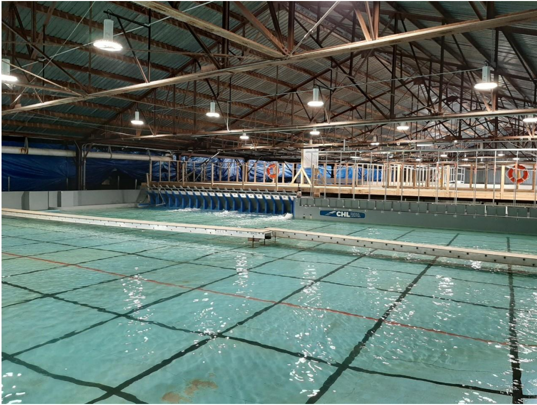
照片 2-17 John Day 水壩模型試驗情形
