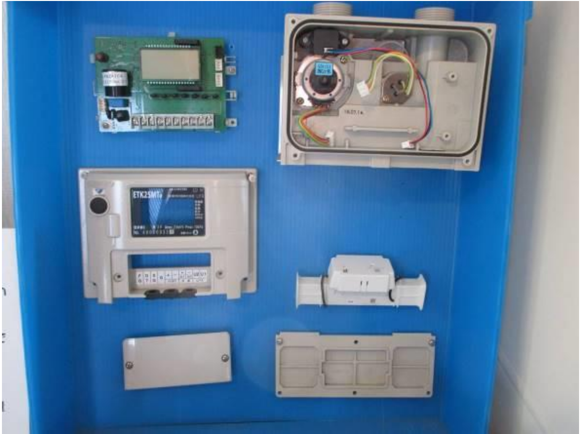
圖 27 超音波氣量計零件圖
