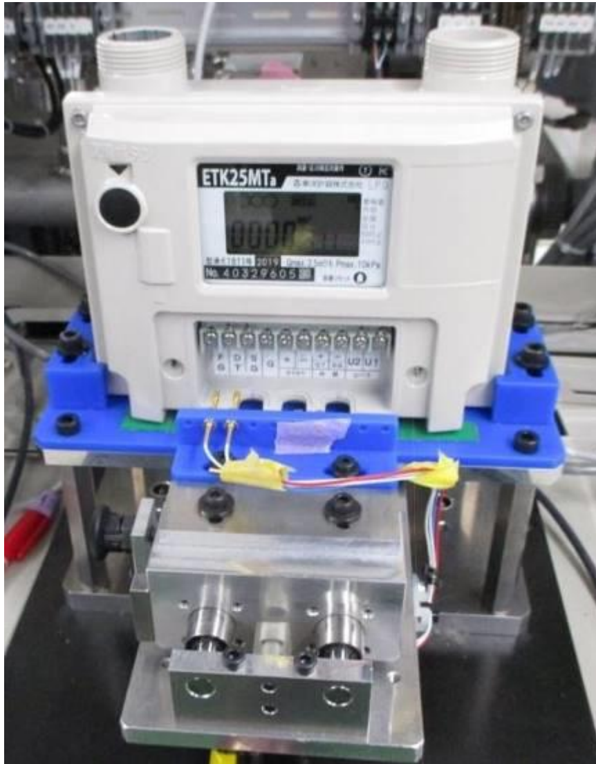
圖 29 器差測試產線讀取超音波氣量計脈波數設備
