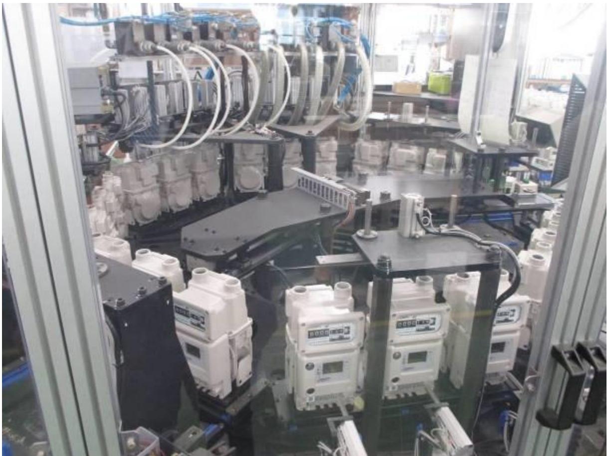
圖 23 自動化遮斷測試
