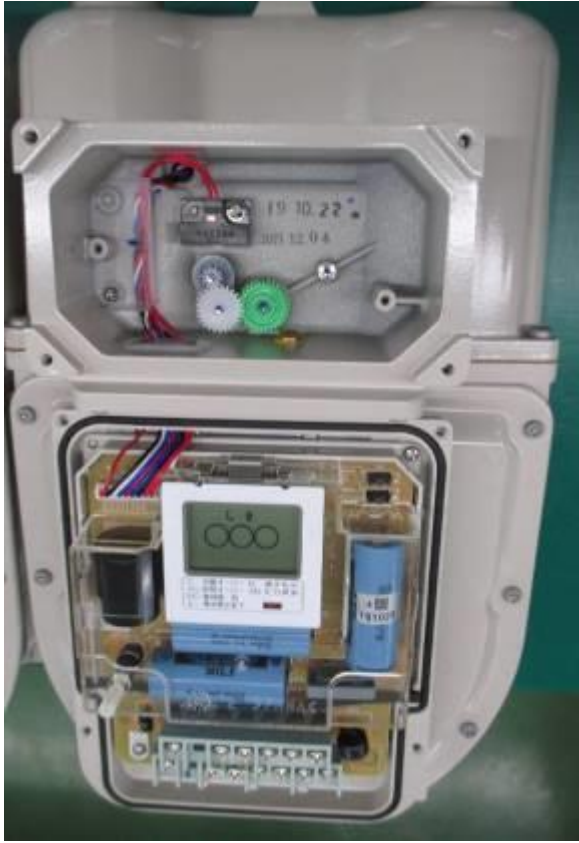
圖 18 微電腦氣量計構造
