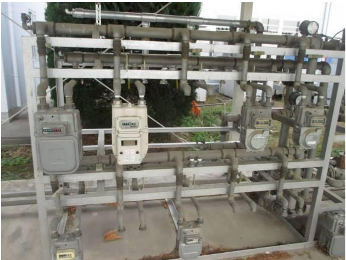
圖 16 耐久性測試中的氣量計
