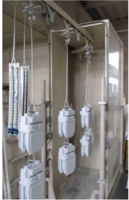
圖 19 自動化噴漆軌道
