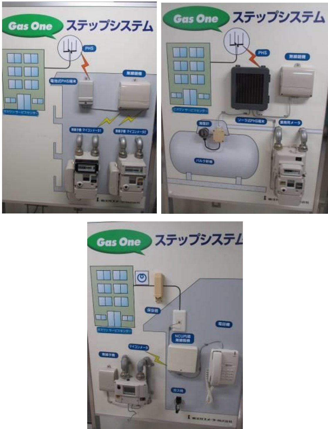
圖 2、智慧型氣量計與瓦斯公司之連線方式
