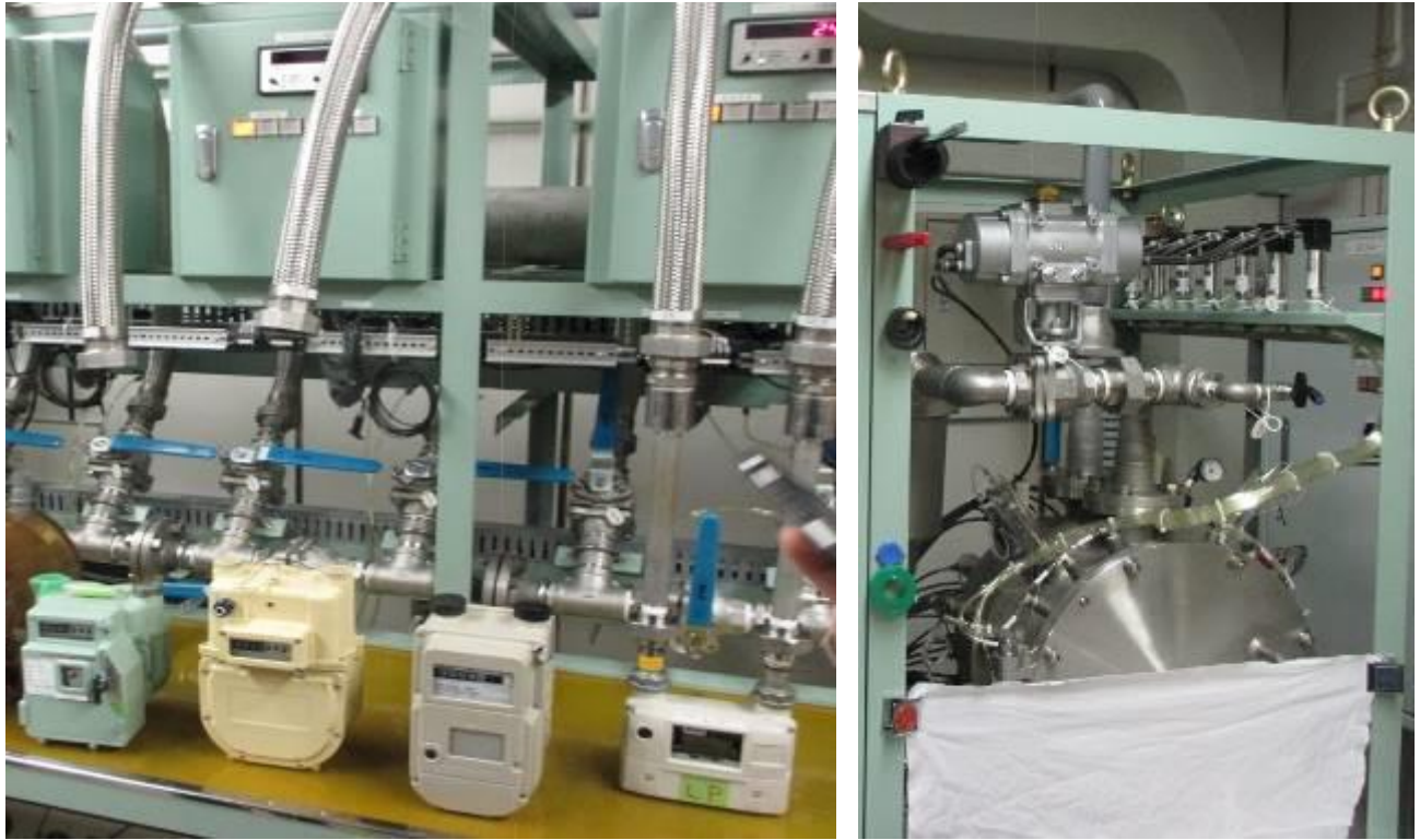
圖 6 器差測試設備及標準器音速噴嘴
