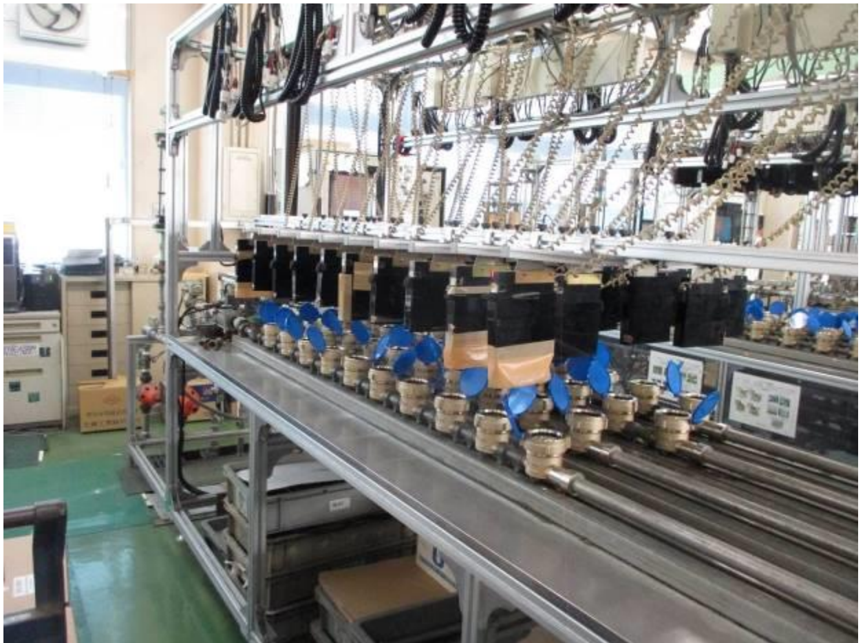
圖 25 水量計檢測器差產線
