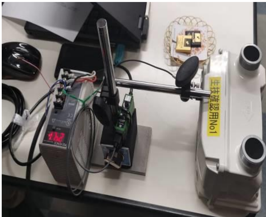
圖 30 紅外線讀取超音波氣量計閃燈訊號
