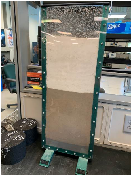
鋪面各層別(基層、底層及面層)模型
