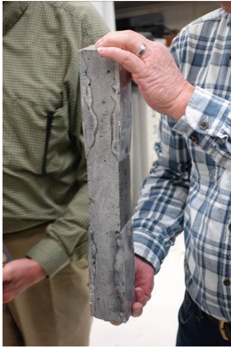
水泥混凝土新試驗方法試體(類似抗劈裂能力)
