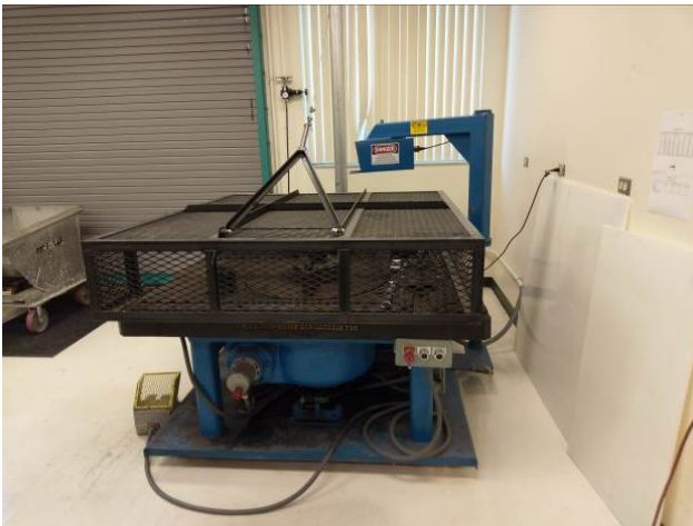
鋼筋彎曲試驗
