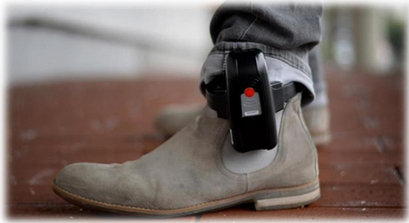
GÜL 採用的 GPS 電子監控設備外觀
