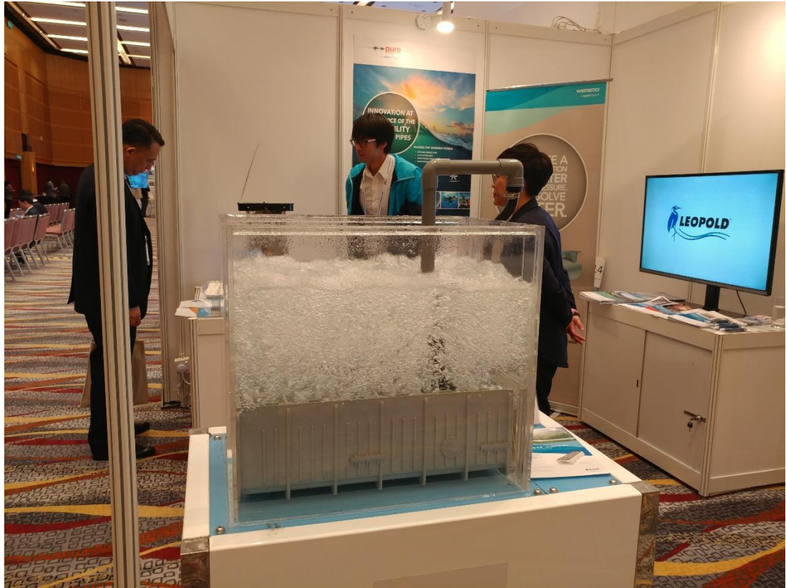
圖 75 賽萊默有限公司展示之 XA 雙通道濾水器(安裝於過濾池底於反洗時使用)
