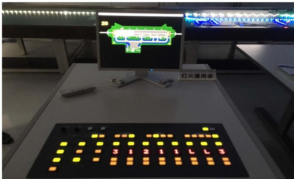
圖 26 機場燈光系統模型操控面板
