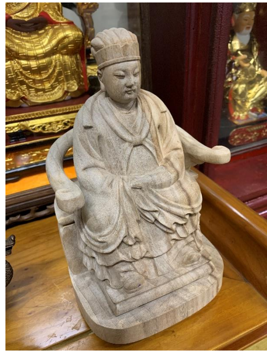
以 CNC 雕刻粗胚神像，比起過去的車佛仔檯機來的更細緻
