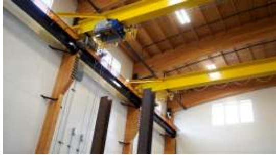
圖表 12 APA 新實驗室物理試驗天車設備
