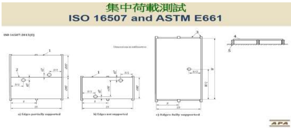
圖表 15 集中荷載測試 ISO 16507 and ASTM E661
