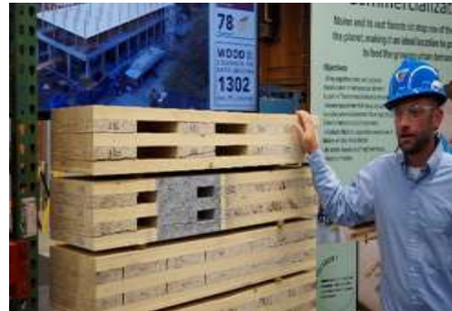
圖表 3 透過間隙尺寸的建模技術，模擬與試驗間隙大小影響的效應
