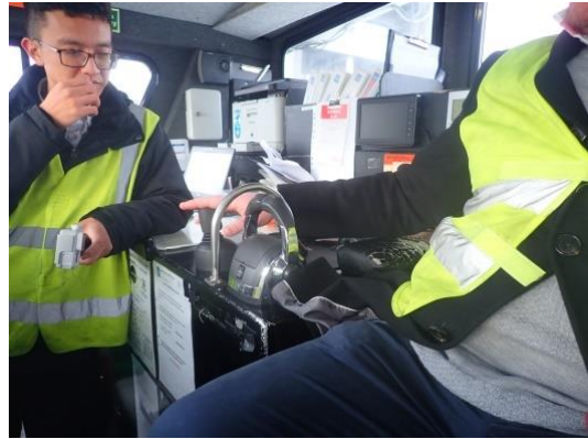
U. 操控設備(第一套:推進器+轉舵; 第二套:搖桿(低船速使用))
