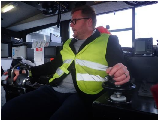
U. 操控設備(第一套:推進器+轉舵; 第二套:搖桿(低船速使用))
