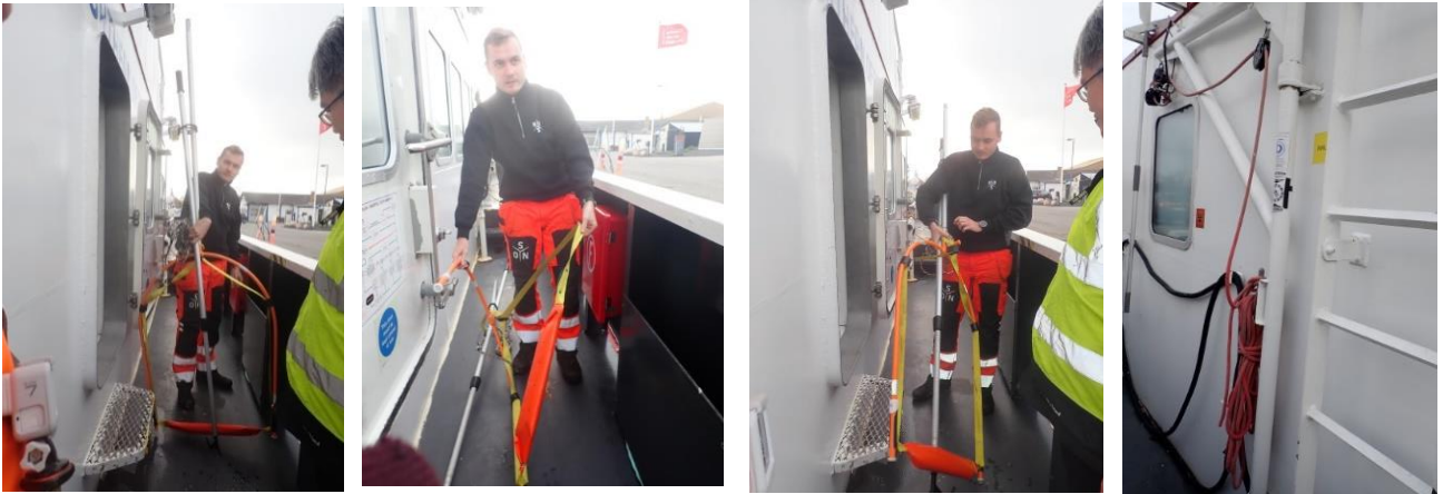
O. MOB人員落水救援設備(吊桿+套索+勾桿)
