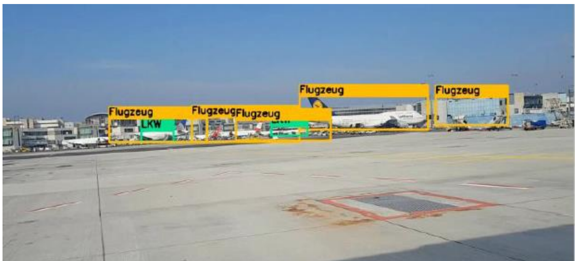
圖 10 影像結合人工智慧辨識空側航機動態
