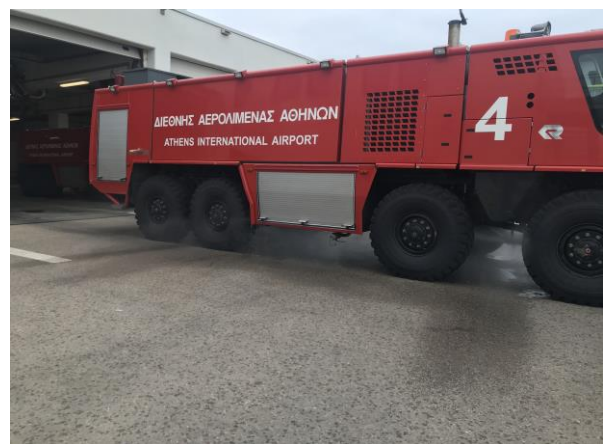
圖 19：消防車底灑水裝置
