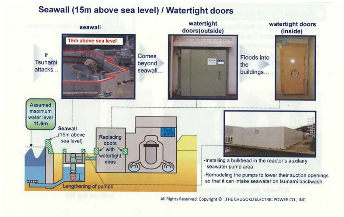
圖 22：島根核能電廠海嘯牆及水密門資訊
