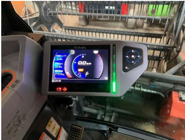
圖 29.熊本杉卡米農場所見含食味及收量感測器之水稻收穫機，稻穀一經採收即可直接進行米質食味測定，本裝置為感測顯示器。
