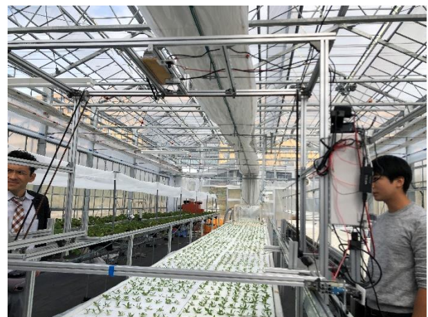
圖 4. 九州大學安武大輔准教授說明所研發影像監視以掌握作物光合成速度來進行生長與生產預測之系統
