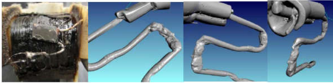
圖 44 使用 3D X-ray CT 掃描第 41 號樣品換氣扇 TCO
