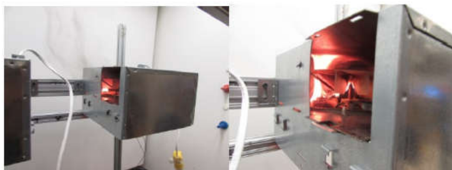
圖 40 TCO 短路對換氣扇執行堵轉試驗(第 3 次)
