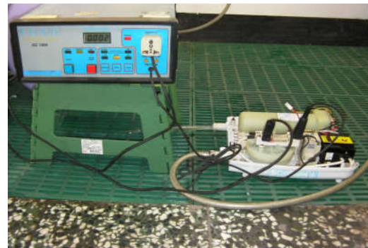
圖 59 全新樣品之接點開關接觸電阻值
