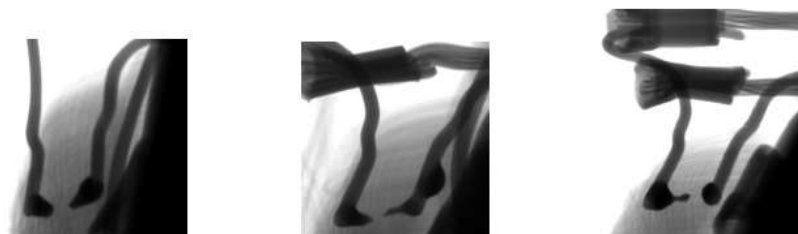
圖 39 溫度保護元件內部熱熔斷合金結構(2/2)
