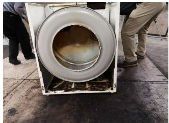
圖 10 烘衣機模擬內部衣物起火耐燃測試結果(2/2)
