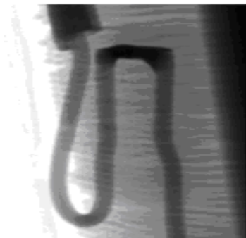
圖 35 溫度保護元件內部熱熔合金結構(1/2)
