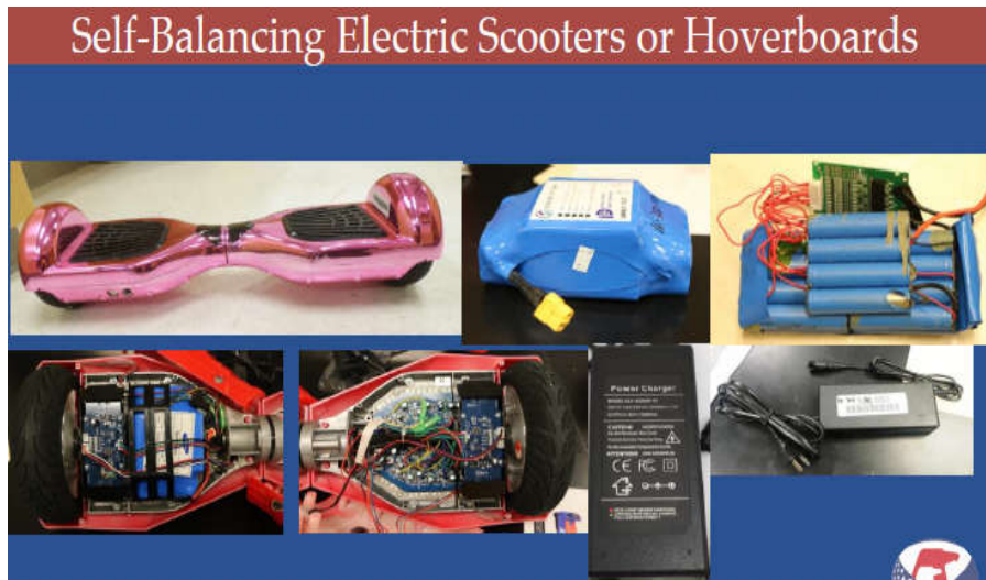
圖 21 電動平衡車及其內部結構(摘自 CPSC 簡報內容)
