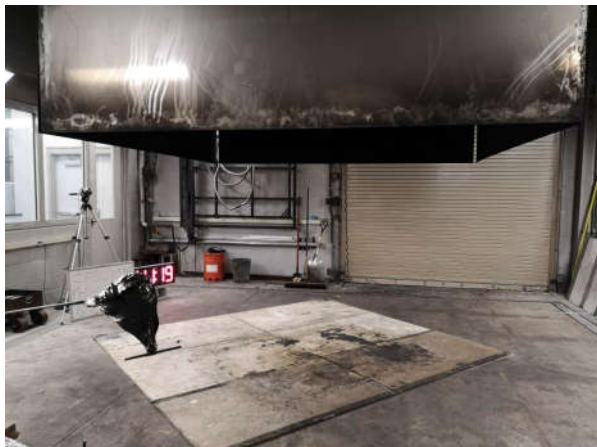
圖 4 大型物件耐燃測試平台
