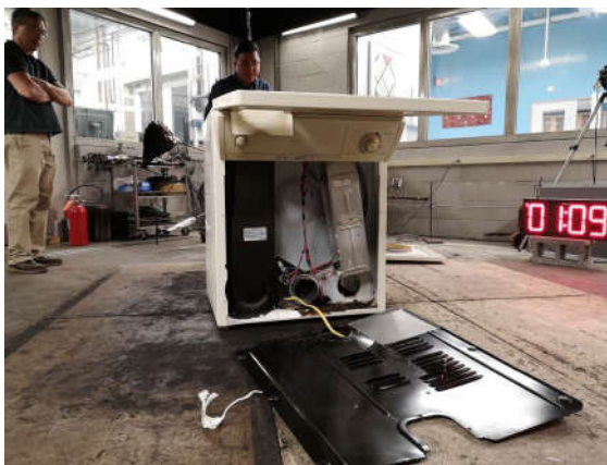
圖 9 烘衣機模擬內部衣物起火耐燃測試結果(1/2)
