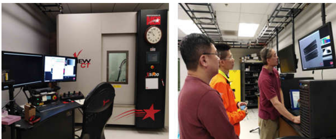
圖 48 示範使用 X-ray CT 對鋰電池組進行非破壞性檢測
