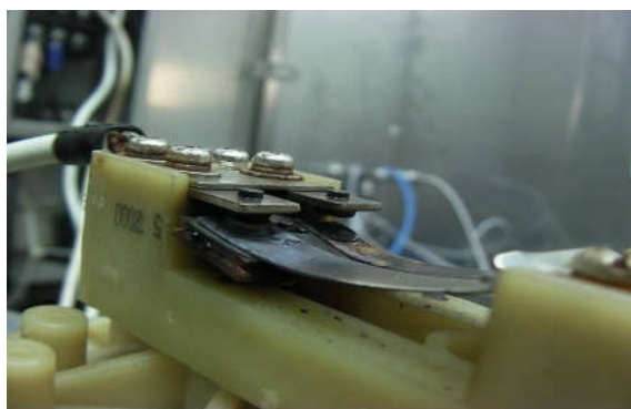
圖 62 事故商品接點開關熔接照片
