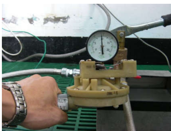
圖 55 水盤開關耐壓測試(10kg/cm 2 )
