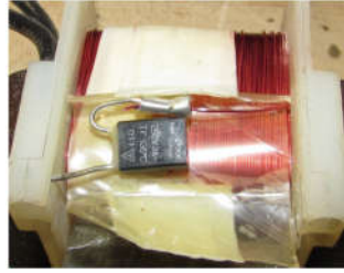
圖 34 蔽極式馬達內部的溫度保護元件
