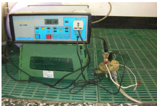
圖 58 事故樣品之接點開關接觸電阻值
