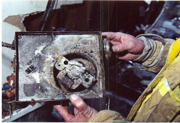
圖 31 換氣扇事故商品外觀
