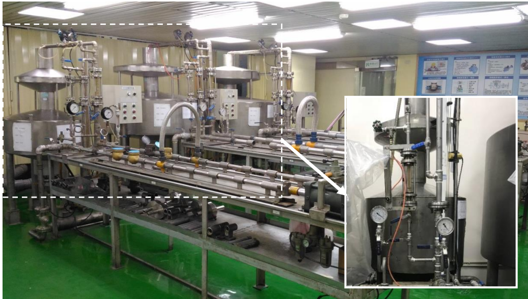
標準檢驗局水量計實驗室 → 容積法（靜態式）
