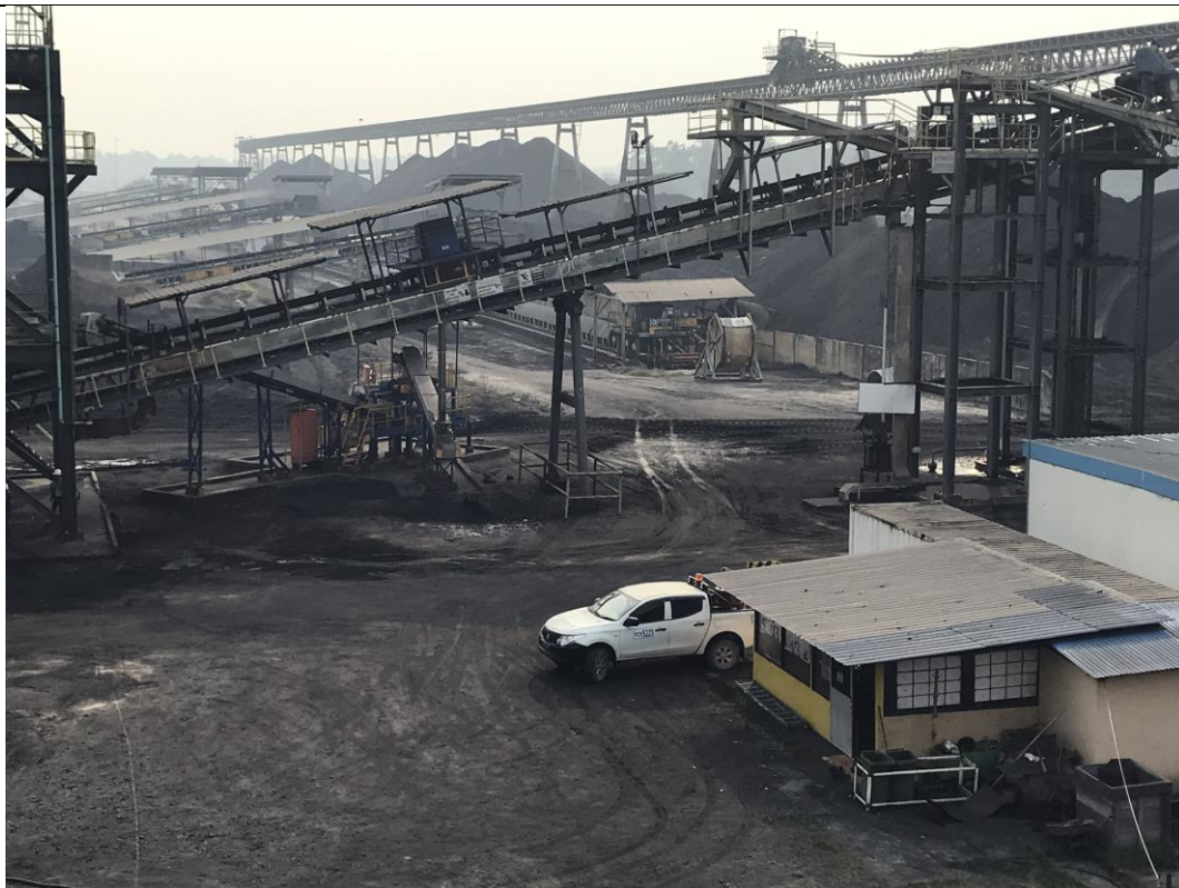
圖1-11：Bharinto煤礦CHPP產品煤皮帶機及自動取樣設備
