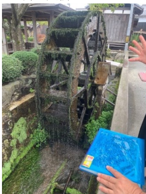
照 133 水車發電供給社區的公園路燈
