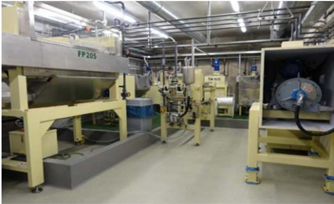
圖十三、Aqua Save II DEC 板框壓濾機
