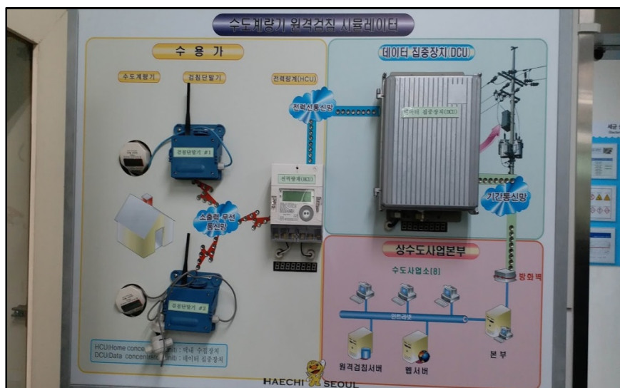
照片4 使用電力和通信線路的遠程抄表系統介紹
